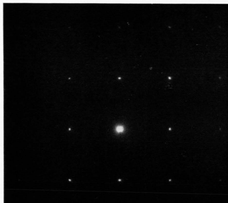
Abb. 4. Durchstrahlungsdiagramm einer einkristallinen Eisenschicht. Einstrahlrichtung 100. Die Schicht wurde durch Aufdampfen von Eisen auf eine NaCl-Unterlage bei 450^\circ\text{C} hergestellt. Sie zeigt im Gegensatz zu den Reflexionsaufnahmen Abb. 6 und 8, bei der die Eisenoberfläche etwa gleichen Oxydationsbedingungen ausgesetzt war, kein Oxyd.
